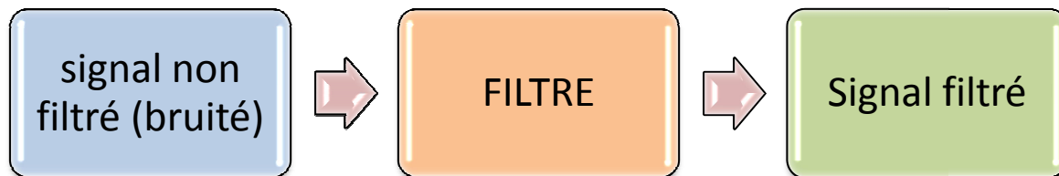
Figure3.1 structure générale d'un filtre.
