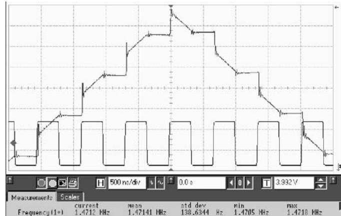
Fig. 6.25 : Réponse temporelle du circuit S/B à un signal triangulaire en entrée
