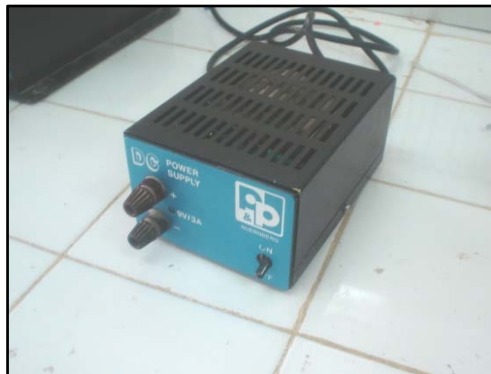
Figure IV.2 : L'alimentation du ROB3 (9V 3A)
