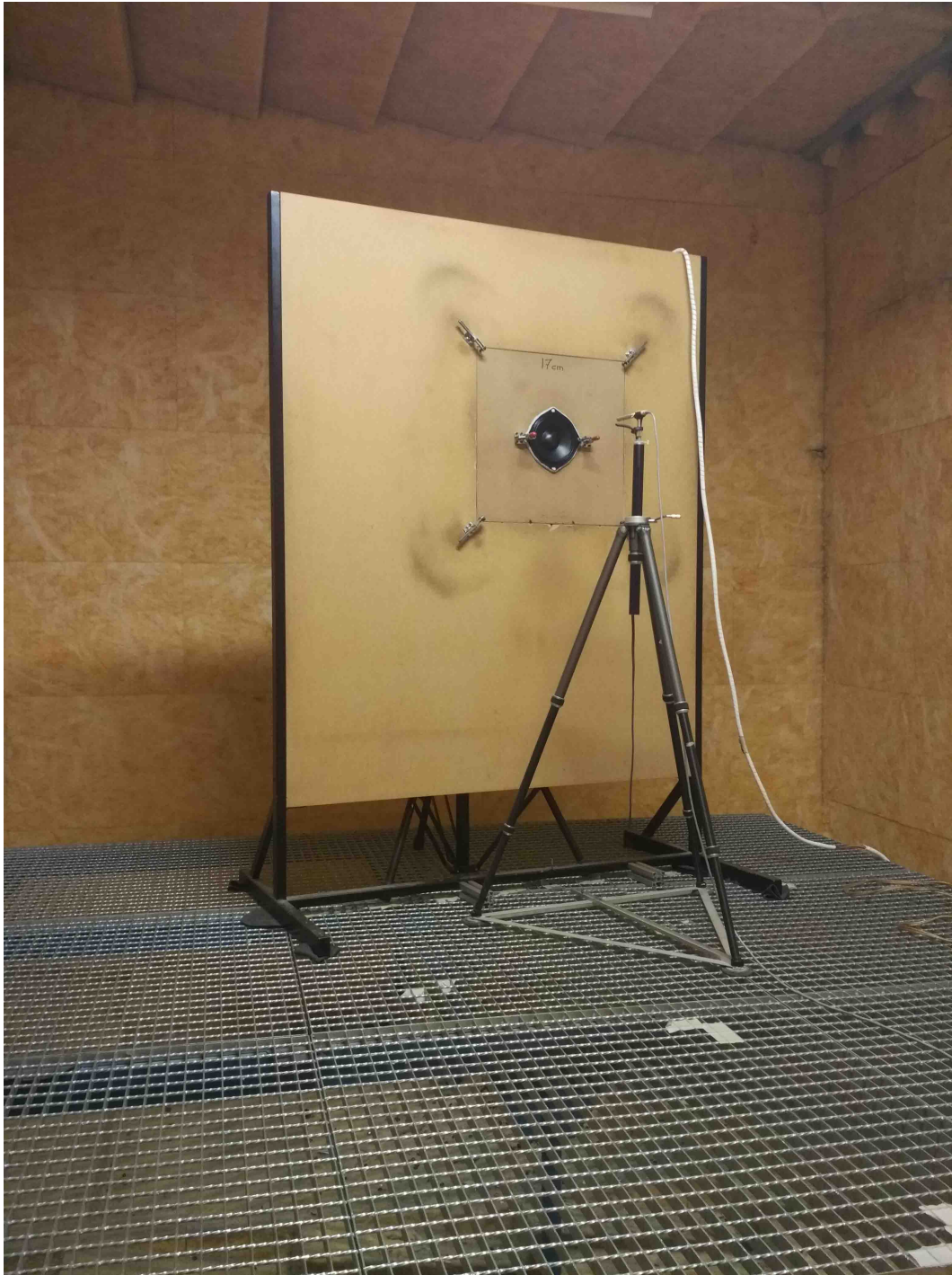
FIGURE 1.12 – Salle anéchoïque de PHL Audio avec le haut-parleur modifié dans le cas du montage en baffle plan infini.
