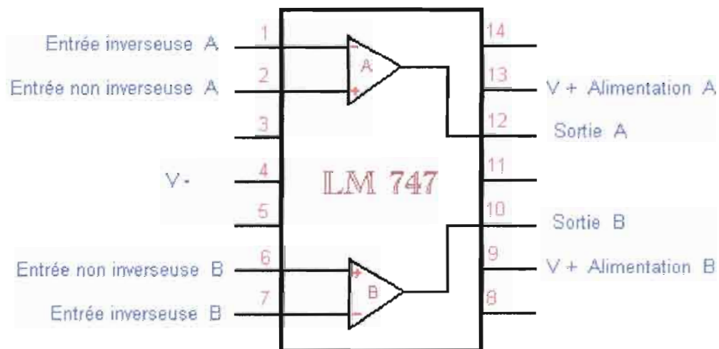
- Brochage du circuit intégré LM 747.
