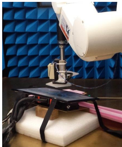
figure 46. Boîtier Volvo incliné par rapport au plan de masse
