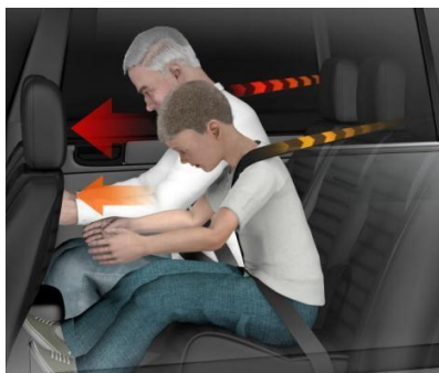
figure 4. Ceinture rétractile avec un contrôle électronique
