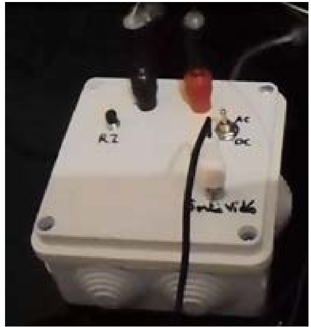
Figure IV. 11: Montage du mini-voltmètre AC-DC ici à affichage sur téléviseur LCD.
