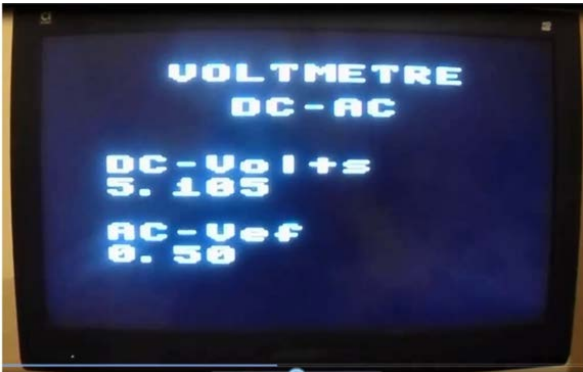
Figure IV. 14: Mesure au moyen de notre mini-voltmètre et affichage au moyen de téléviseur LCD, des tensions continues et alternatives.
