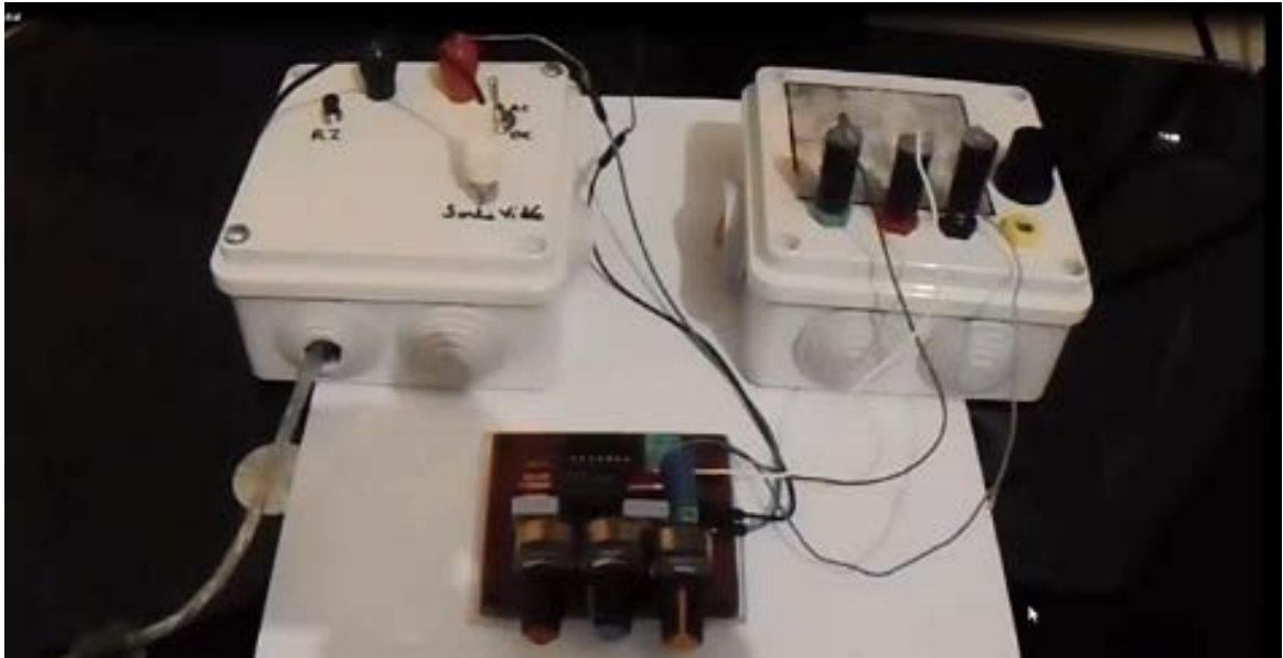
Figure IV. 13: Tests pratiques appliqués à notre mini-voltmètre AC.
