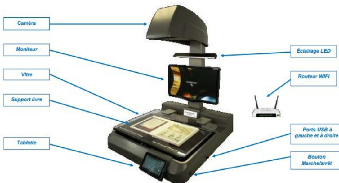
Figure 4 - Configuration du scanner avant la numérisation. Source i2S – Spigraph.
