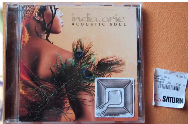
Fig 6.3 : La puce RFID remplace le code barre et sert d'antivol
