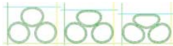
Modélisation d'un essai de compactage de coques et visualisation du champ de contraintes
