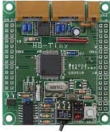
FIG. 7 – Carte basée sur micro-contrôleur H8/3687
