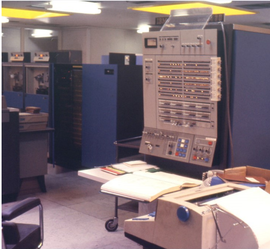
L'IBM 360/67 du CICG (1968-80) Remarquez à gauche le CANAL et les dérouleurs de bande magnétique
