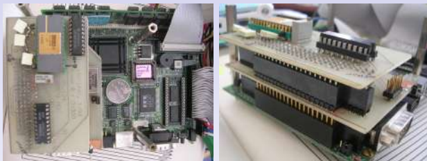
FIGURE – Exemple de cartes d'acquisitions sur bus PC104 (Advantech PCM-4852)
