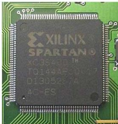
FPGA de Xilinx (modèle Spartan XC3S400) avec 400 000 portes
