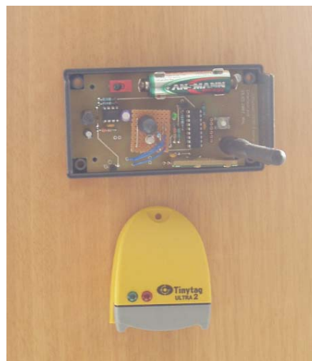
Figure 61: Capteurs internes et datalogger
