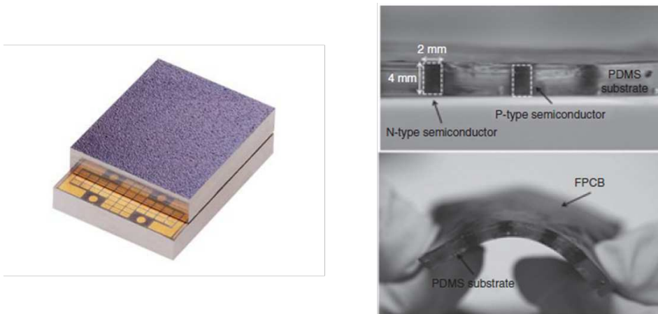
FIGURE A.7 – Générateur Thermoélectrique Micropelt [119] et pour corps humain [94]
