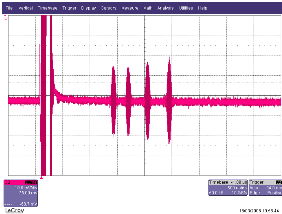
FIG. 5.15 – Visualisation du signal de stimulation et des 4 échos d’une ligne à retard Kongsberg à l’oscilloscope.
