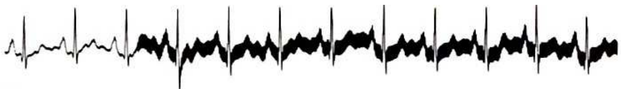
Figure 1.9: interférence de ligne électrique de 50-Hz.
