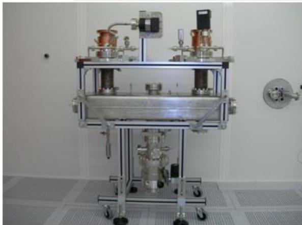
Exemple de la cavité de conditionnement à 704MHz avec ses deux coupleurs (IPNO)
