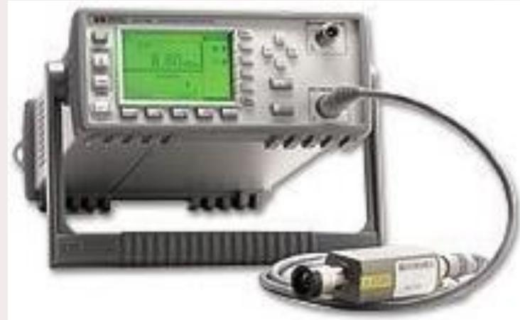
Rôle : Mesure la puissance d'un signal donné.
