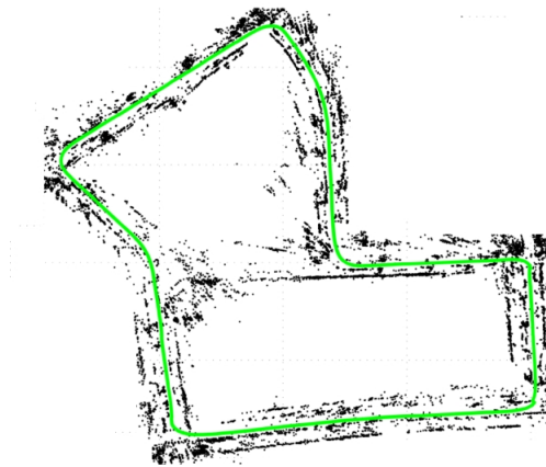
FIGURE 3.11: Résultats de cartographie et de localisation de l'ORB SLAM avec le jeu de données KITTI [2]
