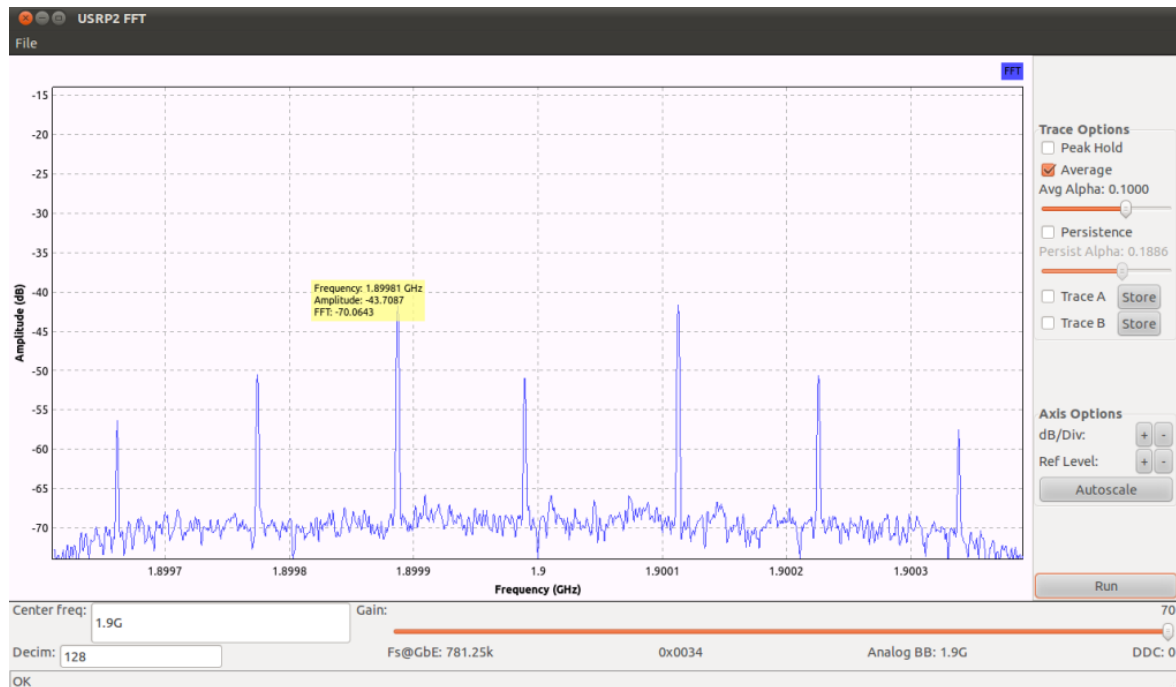
Figure 49 : Mesure effectuée avec bouchon de 50 Ω et fréquence d'accord 1.9 GHz
