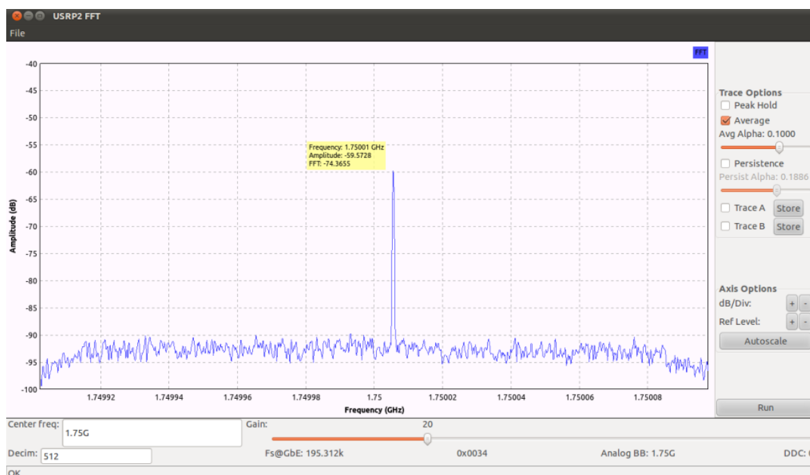
Figure 47: Injection en entrée de l'USRP2 d'une sinusoïde de fréquence 1,75 GHz et de niveau -70 dBm
