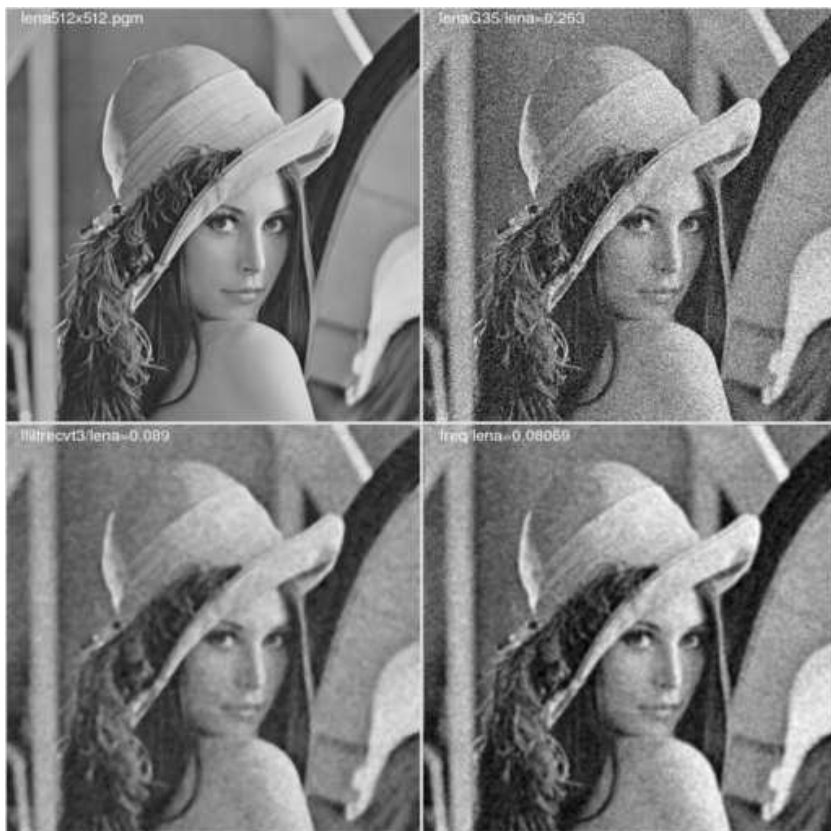
Bruitage avec ipo/brgauss, filtrage avec convert -noise et filtrage fréquentiel par ipo/f2dfreq
