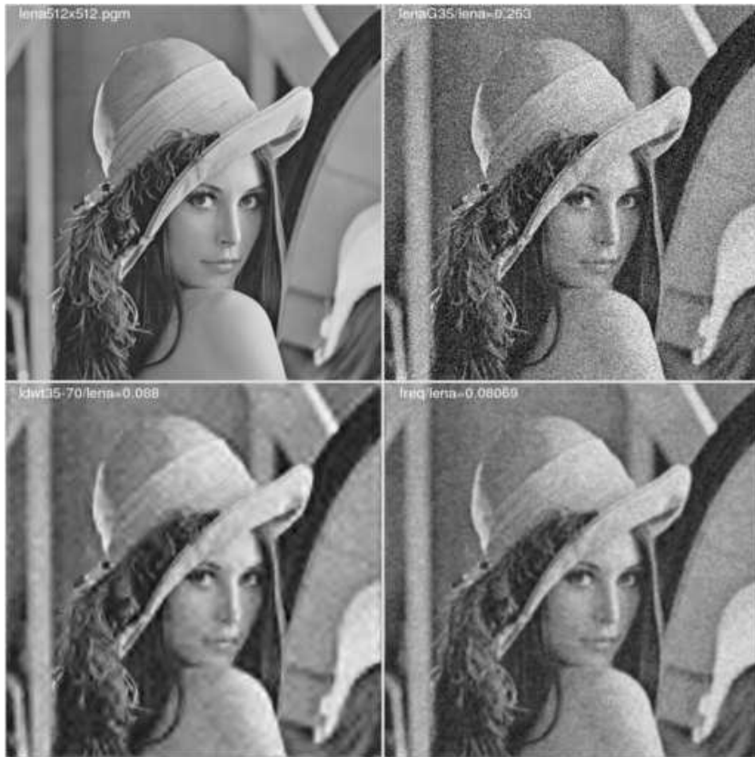
Filtrage avec décomposition en ondelettes par ipo/dwtseuil et avec ipo/f2dfreq
