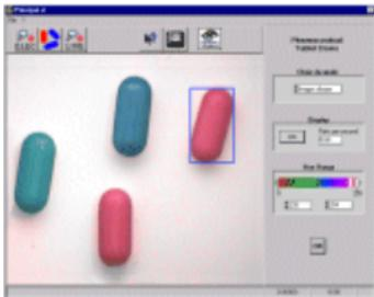
Contrôle d'aspect et des dimensions de gélules pharmaceutiques en mauvaises conditions lumineuses
