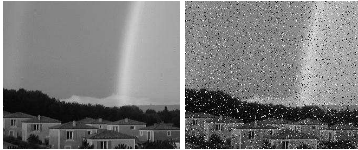
FIG. 10.7 – A gauche, l'image originale. A droite, l'image bruitée avec un bruit de poivre et sel de 10 %
