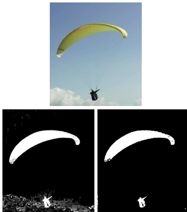
FIG. 8.1 – En haut, l'image originale. En bas à gauche, après lissage (3x3) puis seuillage sur la teinte bleue : certains points isolés erronés apparaissent. En bas à droite : après 2 érosions suivies de 2 dilations d'élément structurant k_s .
