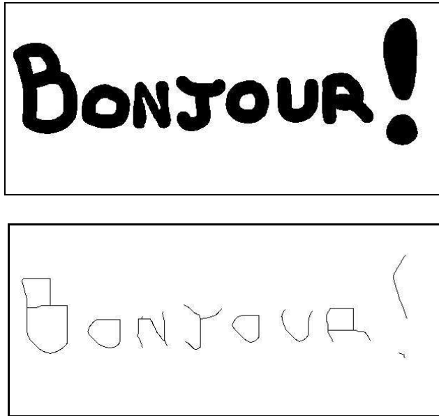
FIG. 7.11 – Une image d'écriture manuscrite utilisant un crayon épais. En prétraitement de méthodes de reconnaissance d'écriture, on peut utiliser la squelettisation. Il ne subsiste alors que les informations principales.
