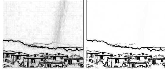
FIG. 6.12 – A gauche : filtre de Sobel et vidéo inverse. A droite, même chose après seuillage simple.
