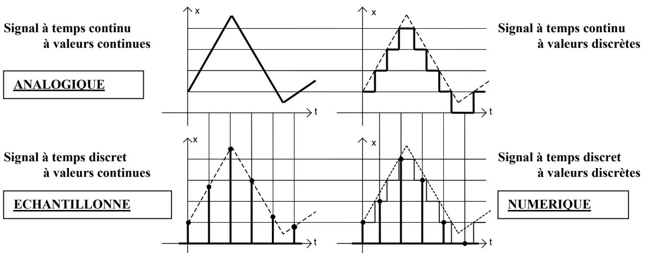
Par échantillonnage on passe d'un signal à temps continu à un signal à temps discret, et une conversion analogique – numérique (accompagnée d'une quantification liée au nombre de bits limités) transforme un signal à valeurs continues en un signal à valeurs discrètes.
