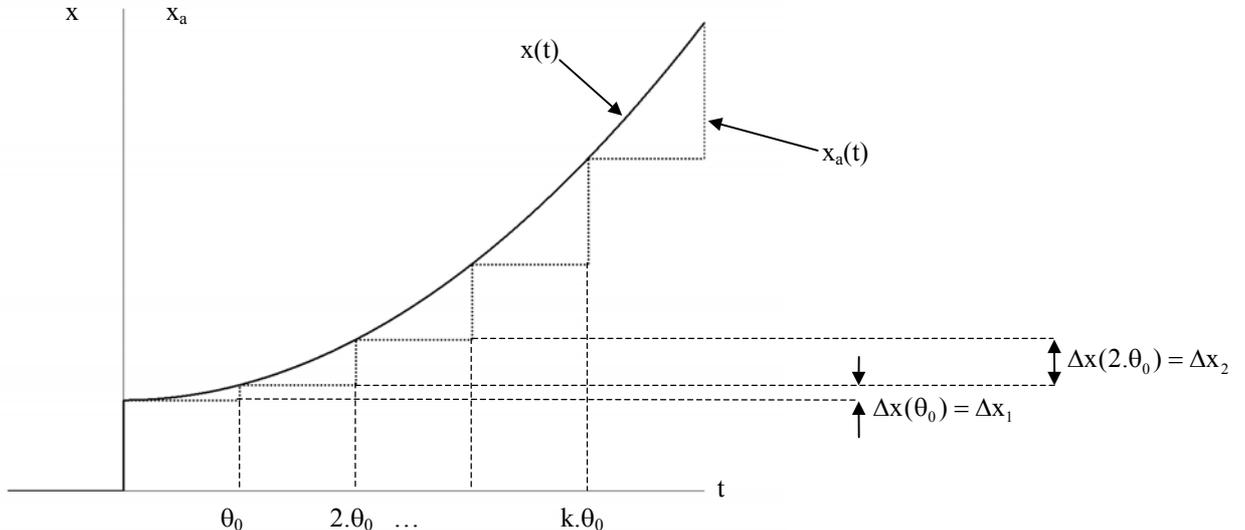
Le signal  $x_a(t)$  est une approximation, en « marches d'escalier », du signal  $x(t)$  (voir les signaux échantillonnés et bloqués). On a évidemment :
