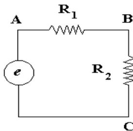
FIG. 7 – Circuit diviseur de potentiel.
