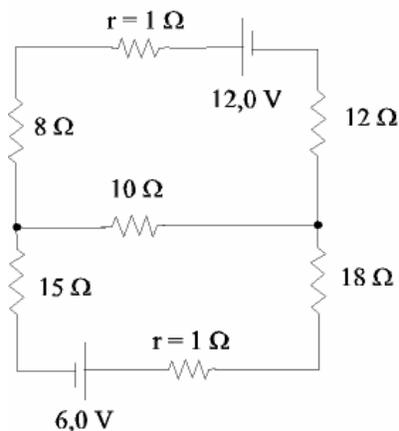
(R :  $I_{12} = 465 \text{ mA}$  ;  $I_6 = 242 \text{ mA}$  ;  $V_6 = 5,76 \text{ V}$ ).
