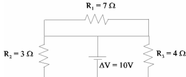
(R :  $I_1 = 0 \text{ A}$  ;  $I_2 = 3,3 \text{ A}$  ;  $I_3 = 2,5 \text{ A}$  ;  $I_{\text{pile}} = 5,8 \text{ A}$ ).
