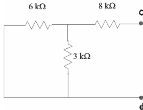
Pour calculer la résistance équivalente entre c et d, on groupe d'abord les résistances de 6 kΩ et de 3 kΩ, qui sont en parallèle :
