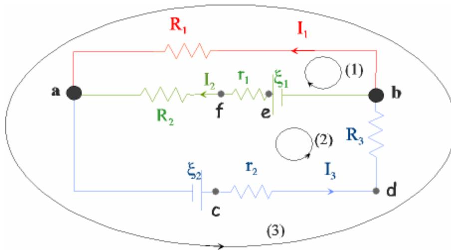
$$\text{maille (1)} : V_{ab} + V_{be} + V_{ef} + V_{fa} = 0 \quad [2]$$
