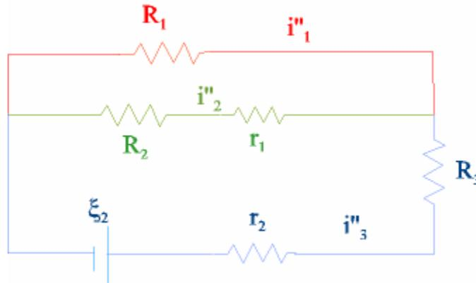
Les résistances  $R_2$  et  $r_1$ , d'une part, et  $R_3$  et  $r_2$  d'autre part, groupées en série donnent une résistance équivalente de  $20,5 \Omega$  et  $30,5 \Omega$  respectivement et la résistance équivalente des branches 1 et 2 groupées en parallèle vaut :  $6,7 \Omega$ , ce qui donne pour résistance totale du circuit :
