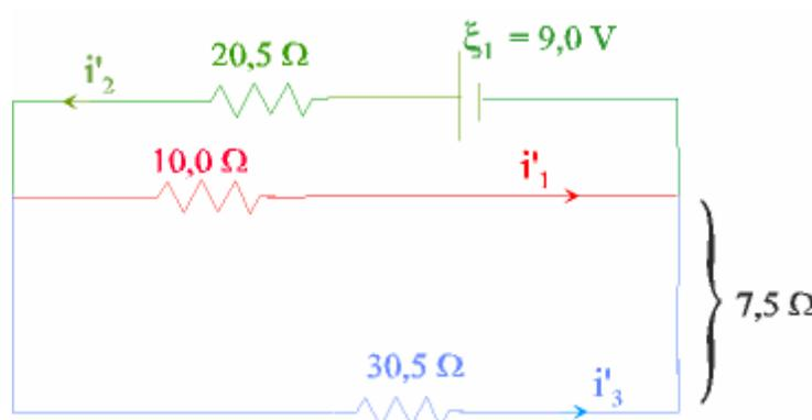
Les branches avec la résistance de  $10,0 \Omega$  et celle avec la résistance de  $30,5 \Omega$  sont en parallèle, ce qui donne une résistance équivalente :
