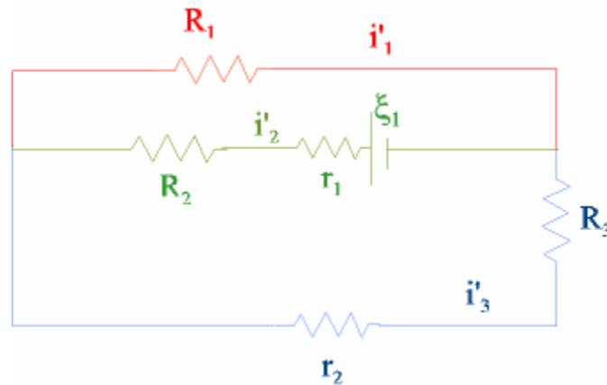
soit  $i'_1$ ,  $i'_2$  et  $i'_3$  les courants dus à  $\xi_1$  dans les branches 1, 2, et 3 définies à la section précédente.  $R_2$  et  $r_1$  sont groupées en série et forment une résistance équivalente de  $20,5 \Omega$ , de même  $R_3$  et  $r_2$  ont une résistance équivalente de  $30,5 \Omega$ .
