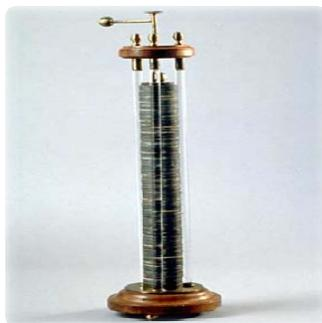
Figure 1 : prototype de la pile de Volta
