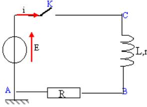
**a Réponse d'un dipôle RL à l'établissement d'un courant** : A la fermeture de l'interrupteur K, le courant électrique  $i(t)$  peine à s'installer et atteint enfin un régime permanent.
