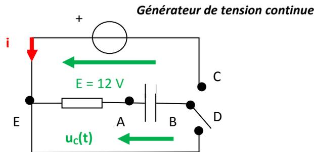
Nous allons réaliser le circuit électrique suivant : on branche dans une maille un condensateur en série avec une résistance. Cette maille peut être en contact avec un générateur de tension continue de 12 V (voir schéma ci-dessous).
