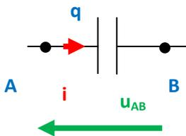
Le courant  $i$  vient alimenter la plaque A en charge  $q$  : le courant  $i$  est par définition la variation de la charge  $q$  par rapport au temps :
