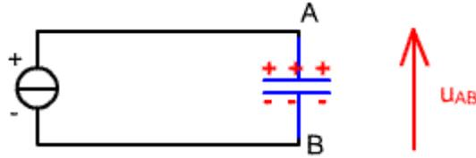
On place en expérience de cours un générateur de courant de 60 mA qui va alimenter un condensateur AB. On observe une hausse progressive de la tension  $u_{AB}$  proportionnelle au temps.
