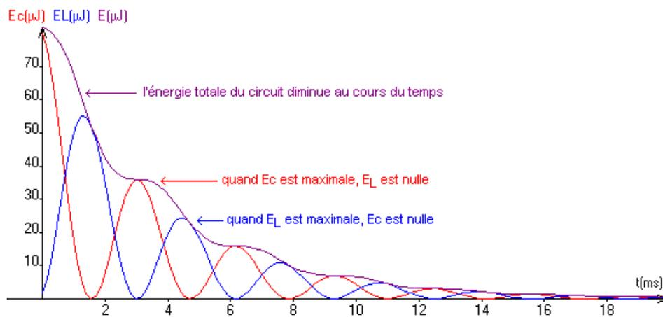
Il existe un montage (connaissance hors programme) qui permet de compenser cette perte d'énergie par l'intermédiaire d'un amplificateur opérationnel. On établit à nouveau un régime périodique avec des oscillations dites libres en changeant une résistance annexe (dite résistance négative !) qui va permettre d'obtenir une sinusoïde fixe.
