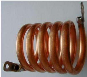
Une bobine (ou solénoïde) est constitué d'un enroulement de fil conducteur recouvert d'un vernis isolant ou, dans le jargon des physiciens, de spires jointives conductrices.
